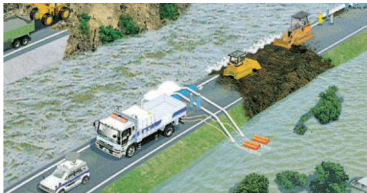
排水ポンプ車配置イメージ（四国地方整備局パンフレットより）
