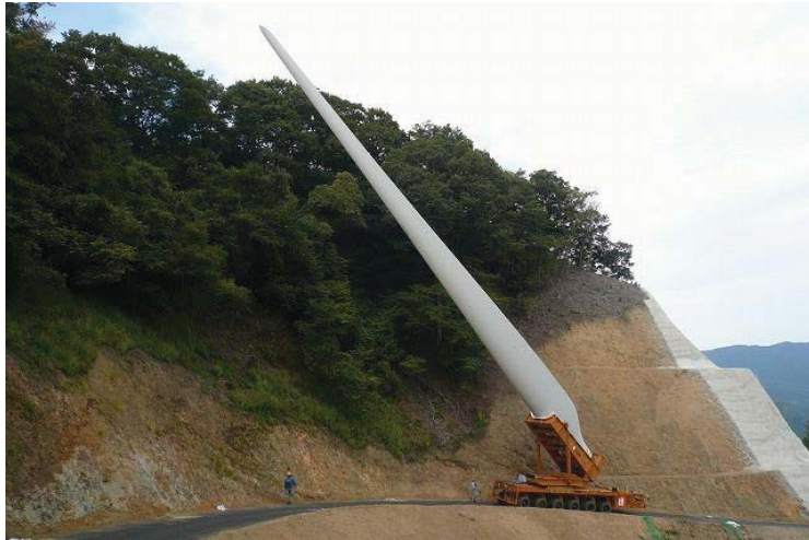
写真 4-1：起立装置車両を使用した道路運搬例
