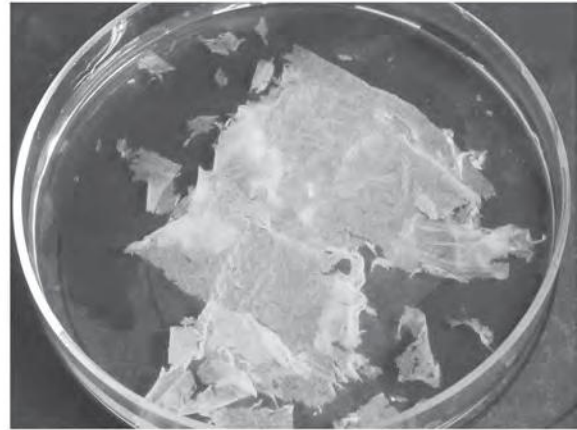
写真6 (F) 試験片の一部破損・分散を認めるが、一部シートの原型を留めた繊維の塊が残る。
