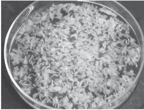
写真3 (C) 試験片が破損分散するが、繊維量が多いため水流の回転数が回復しない。
