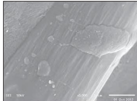
図32 オゾン水処理不織布のaFe固定化状態
