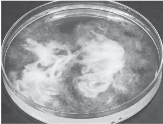
写真5 (E) 試験片の一部破損・分散を認めるが、繊維の塊が残る。
