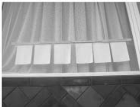
写真2 自然劣化試験の様子
