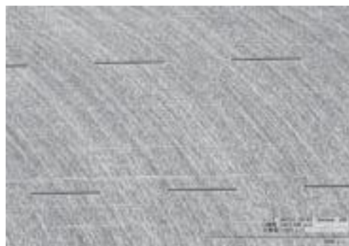
写真1 スリットW40ノズルの拡大写真 (60倍)
