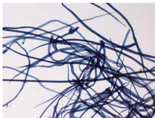
写真 1 試作(稲藁灰+木灰)の光学顕微鏡写真(200倍、C染色液で染色)
