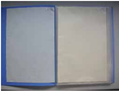
写真6 「天工開物」参考にして試作した竹紙 (左：木灰+藁灰、右：木灰のみ)
