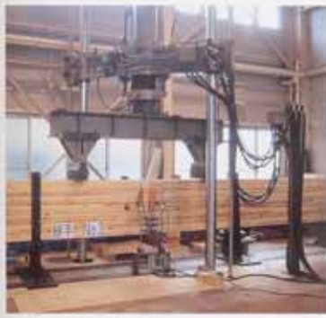
□継手試験体 (上) 試験後の継手部。木の繊維方向に割裂した (右上)
