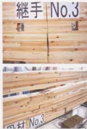
□母材の強度試験
