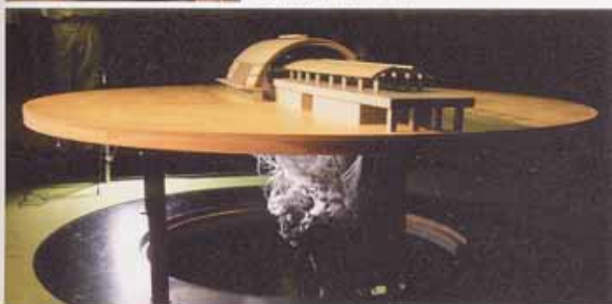
□ターンテーブル上の風洞実験模型 回転させながら16方向の速度圧を測定する。延べ10,000箇所のデータを整理する。テーブル下のチューブの束は速度圧測定用 (下)
