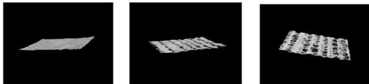
WJ加工後のコウゾ50%・木材パルプ50%紙の表面（倍率20倍・強コントラスト表示）：上段と3D表示（倍率50倍）：下段 左より、未処理、WJ加工 5MPa、WJ加工 3MPa/5MPa
