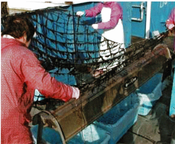
図11 ノリ摘み取り機によるノリ葉体の回収
