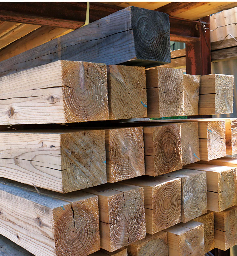
栈木で積み上げる「栈積み(さんづみ)」にして、風の通りを良くし自然乾燥しているスギの芯材。
