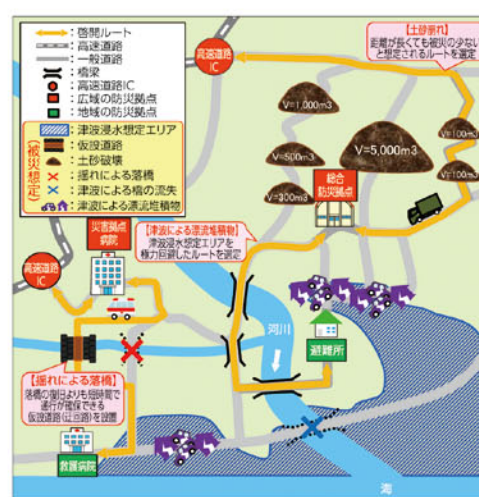
▲道路啓開ルートの選定方法
