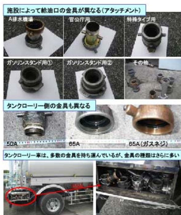
図 8.1.18 タンクローリ側と施設側の給油口を会わせるための各種アタッチメント
