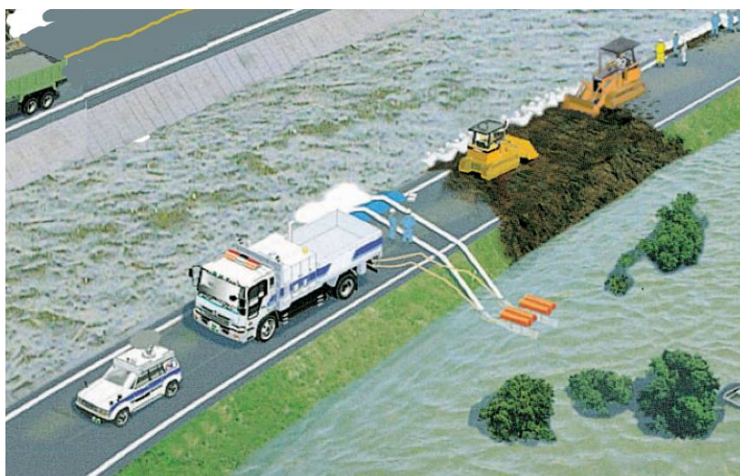
図5.4.8 排水ポンプ車の配置イメージ
