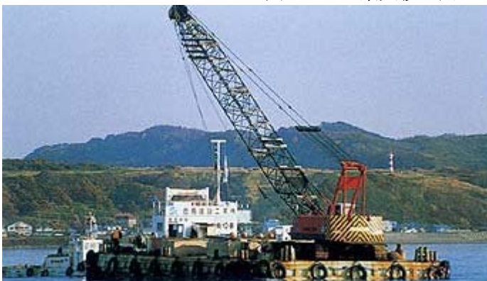
日本作業船協会HPより クレーン台船
