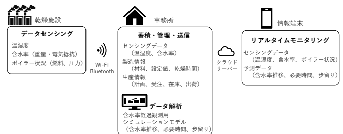
図1 デジタル技術を活用した乾燥材の効率的な生産システムイメージ
