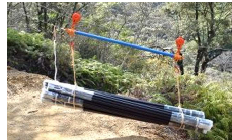
図1 2点吊り搬器と吊り荷の様子
