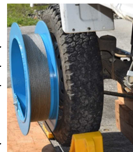
図3 軽トラックホイールに取り付けた作業索用ドラム
