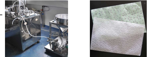
木質素材などを原料とするセルロース ナファイバー製造装置 土佐和紙と生分解性フィルムを使用したケース
