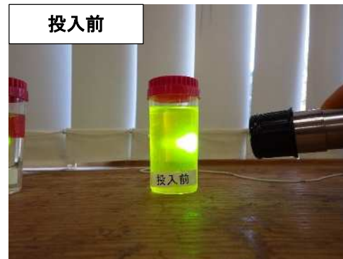
専用ライトによるトレーサー含有の確認
