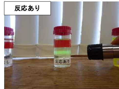
専用ライトによるトレーサー含有の確認
