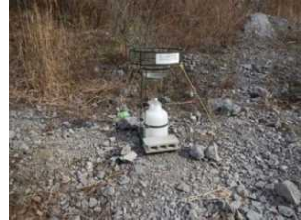
粉じん測定機器の設置状況 （写真は建設予定地）
