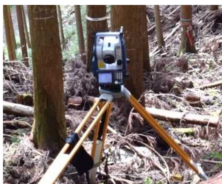
機種名：SOKKIA FX-105F 測角最小表示・精度：5" (1/720°) 測距最小表示・精度：0.001m 測距モード：ノンプリズム、 反射シート、プリズム
