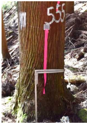
図3 胸高位置までの距離測定用反射シート
