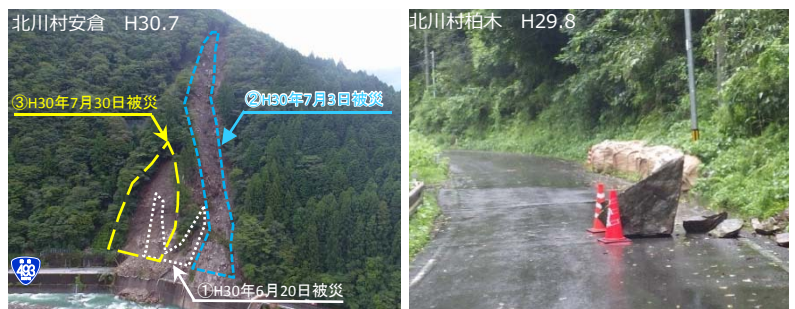
▲急峻な地形、脆弱な地質のため、大規模な土砂崩れが発生 ▲平時でも、200kgを超える落石が発生
