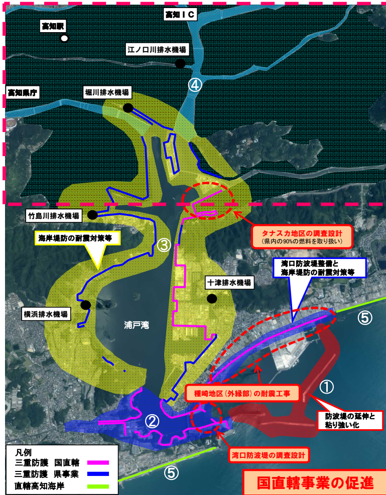
〔三重防護及び河川堤防などの耐震・嵩上げによる整備効果〕
