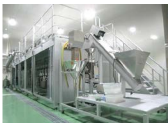
○ユズ精油抽出機器 H29.3月稼働 地域AP No. 8 H28年度産振補助金
