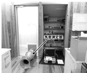
図2 気密性能測定状況
