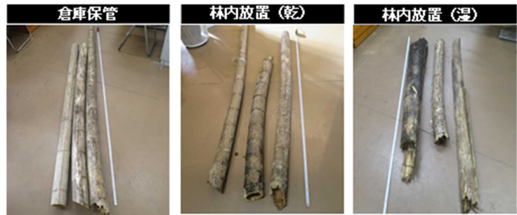
図2 竹(丸桿)の保管条件別外観 (伐採後1年)
