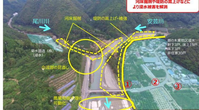
河床掘削や堤防の高上げなどにより浸水被害を解消
