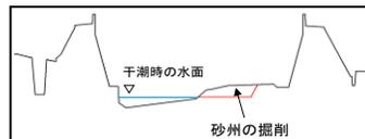
河床掘削により水位低減を図り、高知市の行う内水対策と併せて、浸水被害を低減
