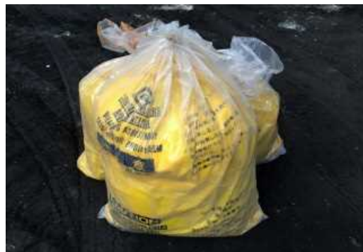
⑤廃石綿等
