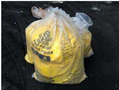
⑤廃石綿等
