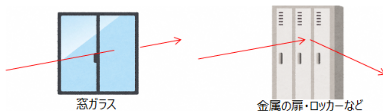
参-図2 電波の特徴 反射や透過など
