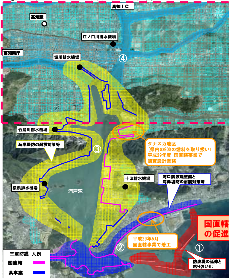
【三重防護及び河川堤防などの耐震・嵩上げによる整備効果】
