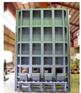
海水ピットに設置する可動式の堰
