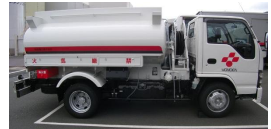
非常用ディーゼル発電機等に用いる重油、および電源車等に用いる軽油の円滑な補給のため、移送配管の設置やミニローリーを配備
