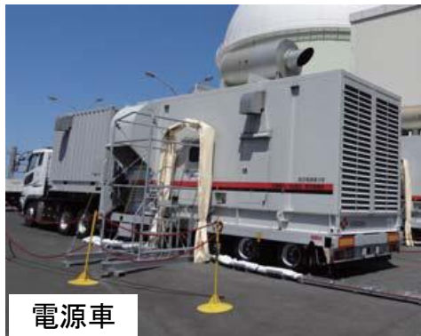
図②-1-4 浸水を想定した代替電源、注水設備
