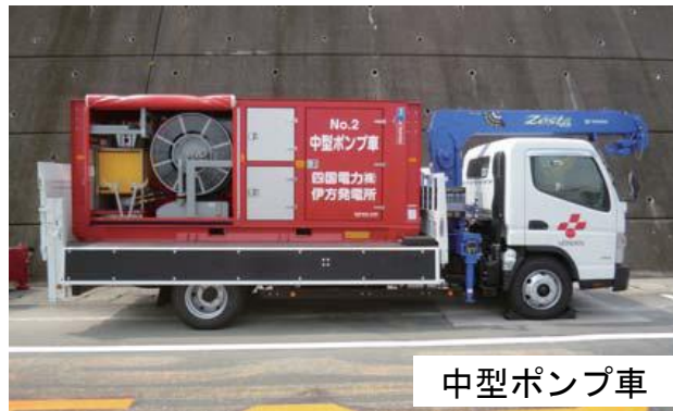
図②-1-4 浸水を想定した代替電源、注水設備
