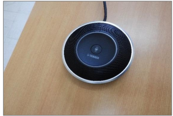
(写真2：中央ボタンを押して、スピーカーの on/off を切り替えて使った)
