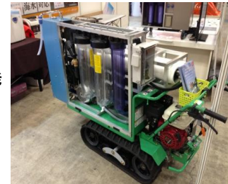
災害対応型 自走式海水淡水化浄水装置
