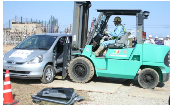
写真:フォークリフト車による持上げ移動
