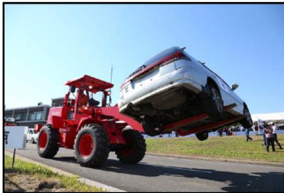
写真 ホイールローダーによる車両移動
