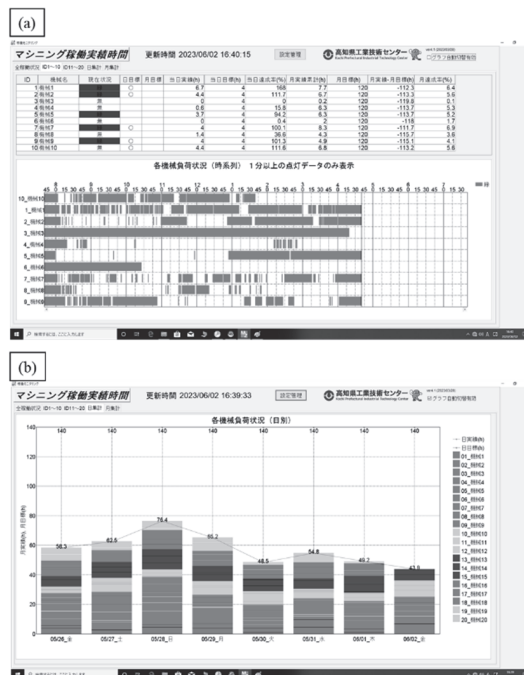
図3 稼働状況をモニタリングする表示画面 (a) 現在の稼働状況を表した画面 (b) 1日の累積稼働時間のトレンド表示
