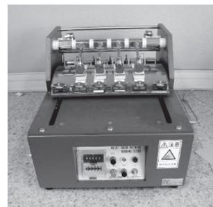
図 1 学振型摩擦堅ろう度試験機
