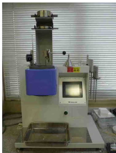
熔融樹脂流動性測定装置
