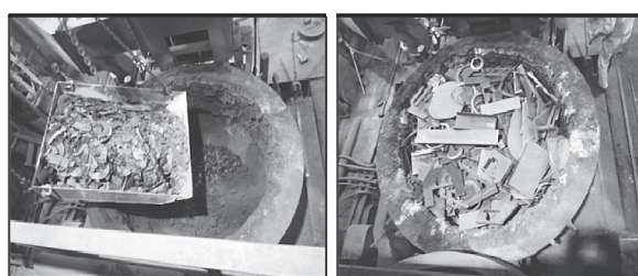
(3) 次に戻り材充填 (4) 最後にスクラップ充填
