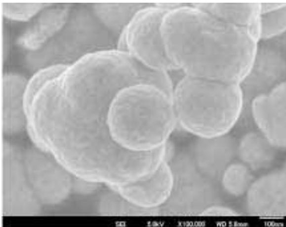
図8 湿式法で合成した合金の繰り返し試験前のSEM像
