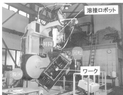
図1 溶接ロボットシステム
