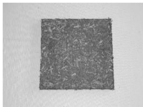
写真 2 樹皮 / MgO 成型体
